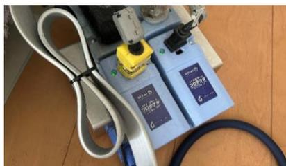
受信ログを付けたり、受信情報を取得するために使っていた PC (Microsoft Surface) 用のサードパーティ製電源アダプタから出るコモンモードノイズを封じ込めるために購入しました。
