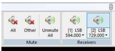
追加された受信機はこのように表示されて、隣の Mute ボタンにより全受信機を Mute したり解除したりすることが出来る。更には Receiver Pane のメニューを押すとスペクトラムウィンドウ内に大きく表示されて、マウスを当てた側の受信機だけ音が聞こえるようなセットも可能である (Audio Preview on Mouse-over を設定)。
