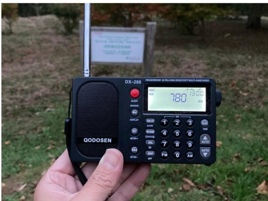
DX-286 のロッドアンテナで北米中波局を受信
