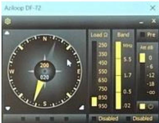
見間違うばかりに同じ色合いの今回の新製品・AZILOOPのアジマスコントロールをするコンパスの画面を見せて頂きました。画面の中では、K9AYループの終段抵抗、プリアンプにアッテネーターの操作ボタンとあり、順番に丁寧に尾原さんの解説を聞いていきます。このAZILOOP、直行する同一サイズのワイヤーアンテナをK9AYとして機能させることにより、指向性を電子的にコントロールする、というものです。BCL少年時代ならクーガーシリーズの様にジャイロアンテナを回して、8の字特性で一番強くなる方向・弱くなる角度を探る操作だったのが、2024年にはこの手元・PC内のマウス・ホイールを回すことで実現しているのは、このアンテナのキャッチ・コピー”Reception Reinvented”（受信方法の再発明・・・）が痛いほどよく伝わってきます。ペルセウス画面内の周波数を前後して、ローカル局に在京大電力局など、幾つかAZILOOPのコントロールを試させていただきましたが、気持ちいい様にマウスの操作だけで指向性が変わります。指向性が変わる、という表現より受信する際の信号強度をいとも
