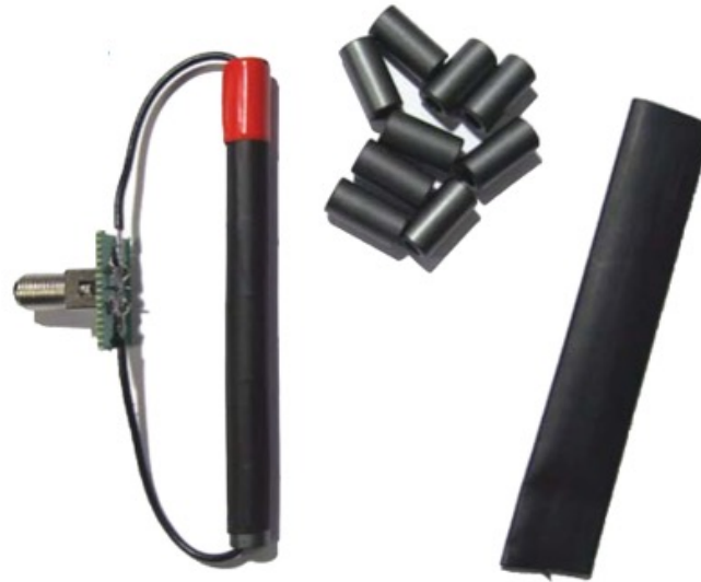
フェライトビーズを連結して作成された電流トランス
