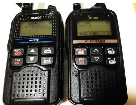
ボタンの配置も同じですので操作は一緒です。待ち受け画面ではIC-DRC1MK IIは日付、曜日、時間が表示されますが、DJ-PV1Dは、チャンネルのみの表示です。
