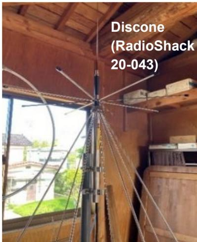
写真 1 受信に使用した SDR とアンテナ
