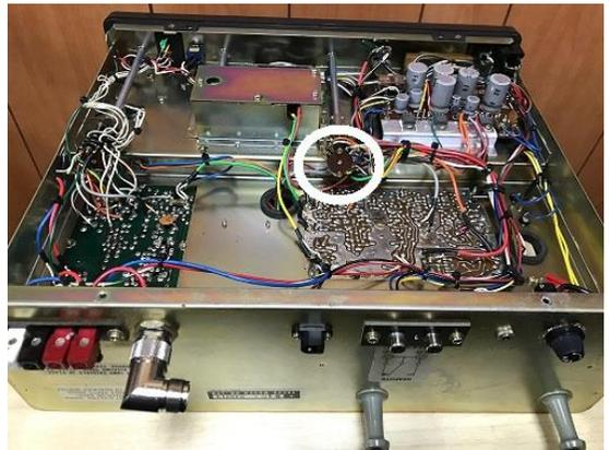
本体カバーを外して底面を見ると、写真のようにモード切替のロータリースイッチが中央部に現れます。
