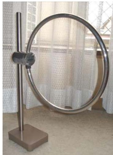
■今回紹介するループアンテナは、JIS C6102-1988「AM放送受信機試験方法」に準じたフェライトバーアンテナ内蔵ラジオの性能測定に使用する試験電界発生用コイルです。直径25cmの円形シールドループアンテナで、整合用固定抵抗を内蔵し、出力インピーダンスが50Ωの信号発生器に接続したとき、コイルの中心軸上でその中心から60cm離れた空芯の棒型アンテナ
