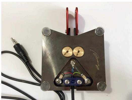
Simplex とケーブルの接続部。付属の 3.5φ プラグ付ケーブルの一方のプラグをカットして、パドルにハンダ付けした
