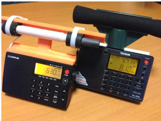
Gary DeBock 氏の手による、7.5 インチ・Loopstick 付きの C. Crane Skywave (左) (右) は、板さんが輸入してくださったリッツ線をシエスタ氏による末端処理、及び最適な巻き数計測により実現した、7 インチ Loopstick 付きの Tecsun PL-380
