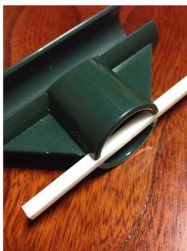
一の下部が角材を噛む様に切り込みを入れて接着した。アンテナへの配線は、中央部分にそれぞれ穴を開けて最短で基盤へと向かう構造。ラジオの裏蓋をメンテの為に開けることも勿論可能だし、ロッドアンテナも使える、ストラップ穴もつぶさずにそのまま機能も残している。こんなスーパーチャージされた PL-380、早速受信してみれば。。。折からのバングラデッシュの好コンディションにより、693kHz、NHK 東京第二放送の停波後、素晴らしい状態の同局が受信出来た。
