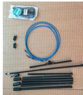
今回使用した”YouLoop”(1周4メートル) (左) 組み立て前。「突っ張棒」の1本は伸ばした状態 青いケーブルは2mと1m+1m (jjコネクタで接続) (右) 新潟の海岸に設置した様子(2022年)
