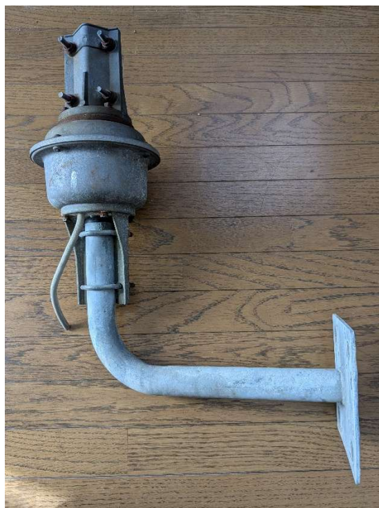
以前使用していた YAESU G-250 写真の通り BS アンテナ基台にねじ止め可能な形状になっており、後継機種も同じ形状だと思い込んでいたのだが...
