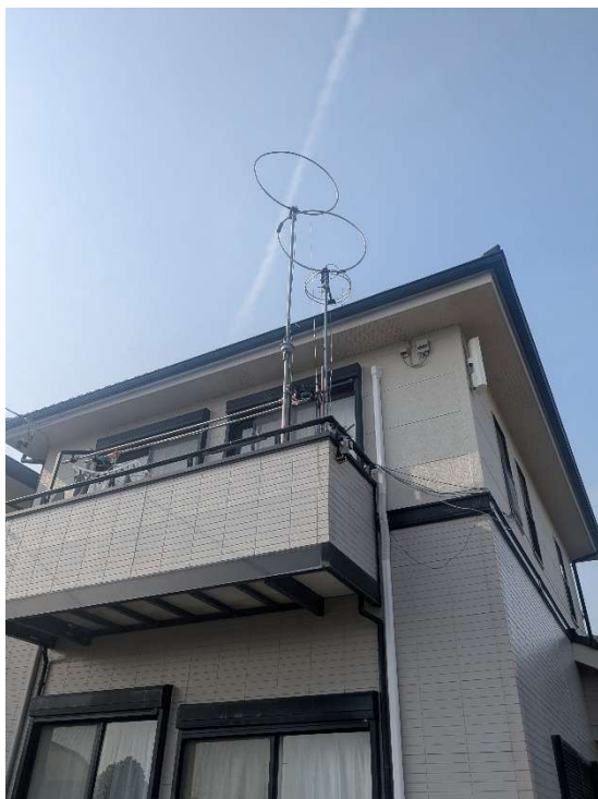
写真に写る 2 つ以外に屋根にも ALA が。海岸までの距離は 900m とのことで Sea gain が期待出来、この機に MWDX 復活を望みたい。
